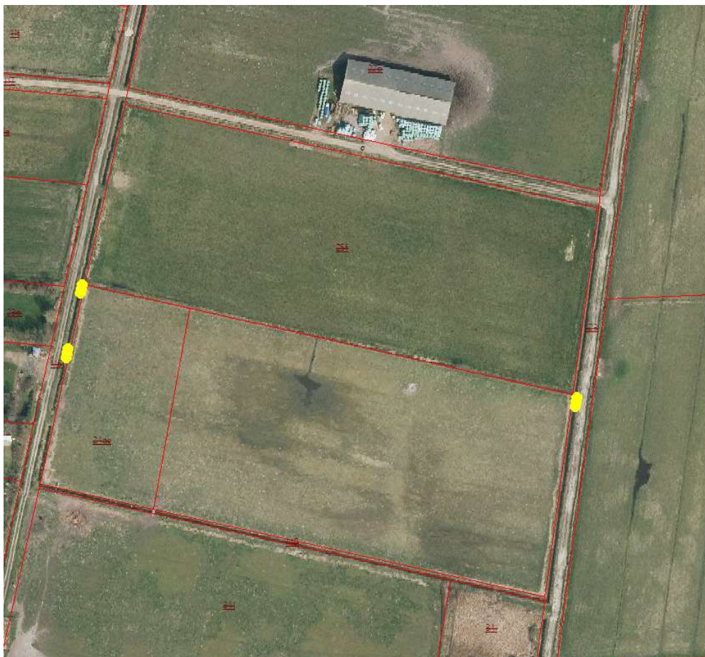
Figur 1. De tre nye overkørsler er indtegnet med gult. De to overkørsler går over Mandø Bygrøft til Mandø Toftevej og overkørslen til højre, mod øst, går over Grøft nord for Midtvej til grusvejen Nedenom.
